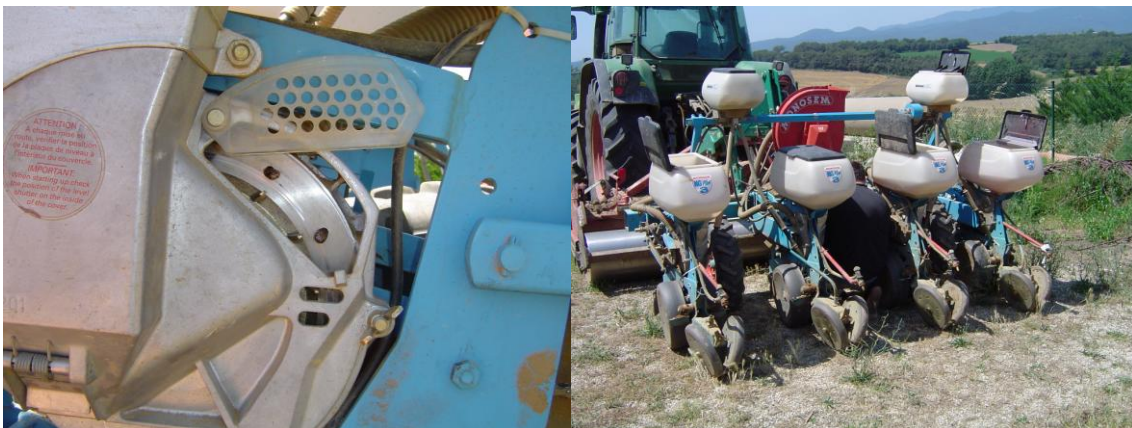
Figura 8. Discos de siembra con 12 perforaciones y sembradora neumática de 4 líneas Manosem.
